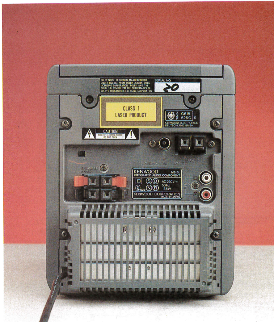
Sul retro troviamo solamente le prese di uscita per gli altoparlanti, le prese di ingresso RCA e per l'antenna del tuner.
